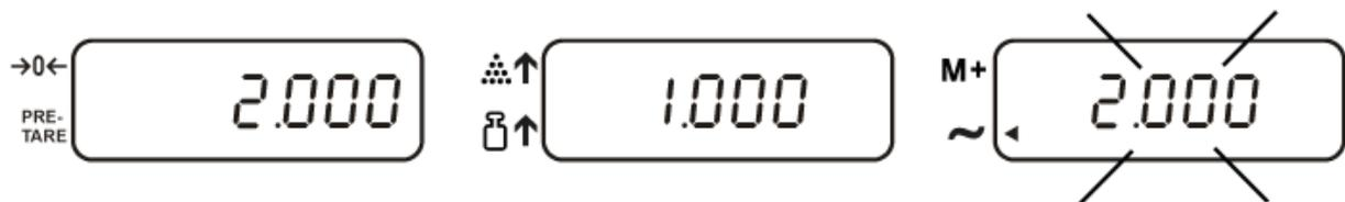
⇒ Validar mediante la tecla
