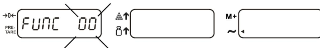
⇒ Introducir el valor "04" usando las teclas numéricas y validar presionando la tecla **MC**. Aparece parpadeando el último valor introducido.
