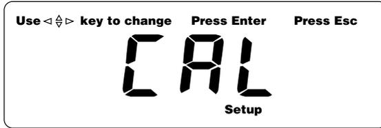
Pulsar las teclas  $\leftarrow$   $\rightarrow$  para desplazarse hasta "SET" para acceder a configuración de parámetros, hasta "CAL.R" para ajuste de span o "CAL.W" para calibración span de peso. A continuación, pulsar  $\leftarrow$  para entrar.
